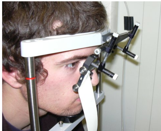
Abbildung 6: Apparatur für die Cornea Reflex Methode , bei welcher Blickbewegungen mit Hilfe von Infrarotreflexionen auf der Hornhaut bestimmt werden
